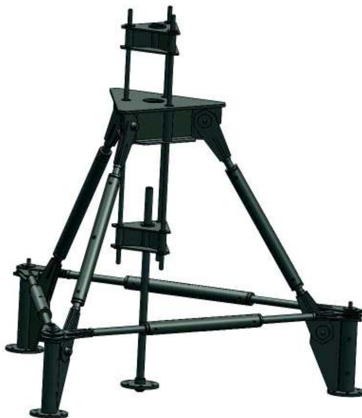
Рисунок 4- Схема станда (УУ-ВСК ) для испытания на выдергивание
