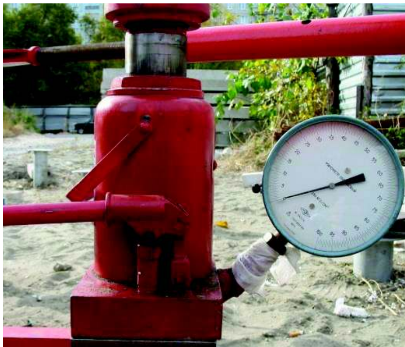
Фото 5- Общий вид домкрата для передачи усилий на испытываемые сваи
