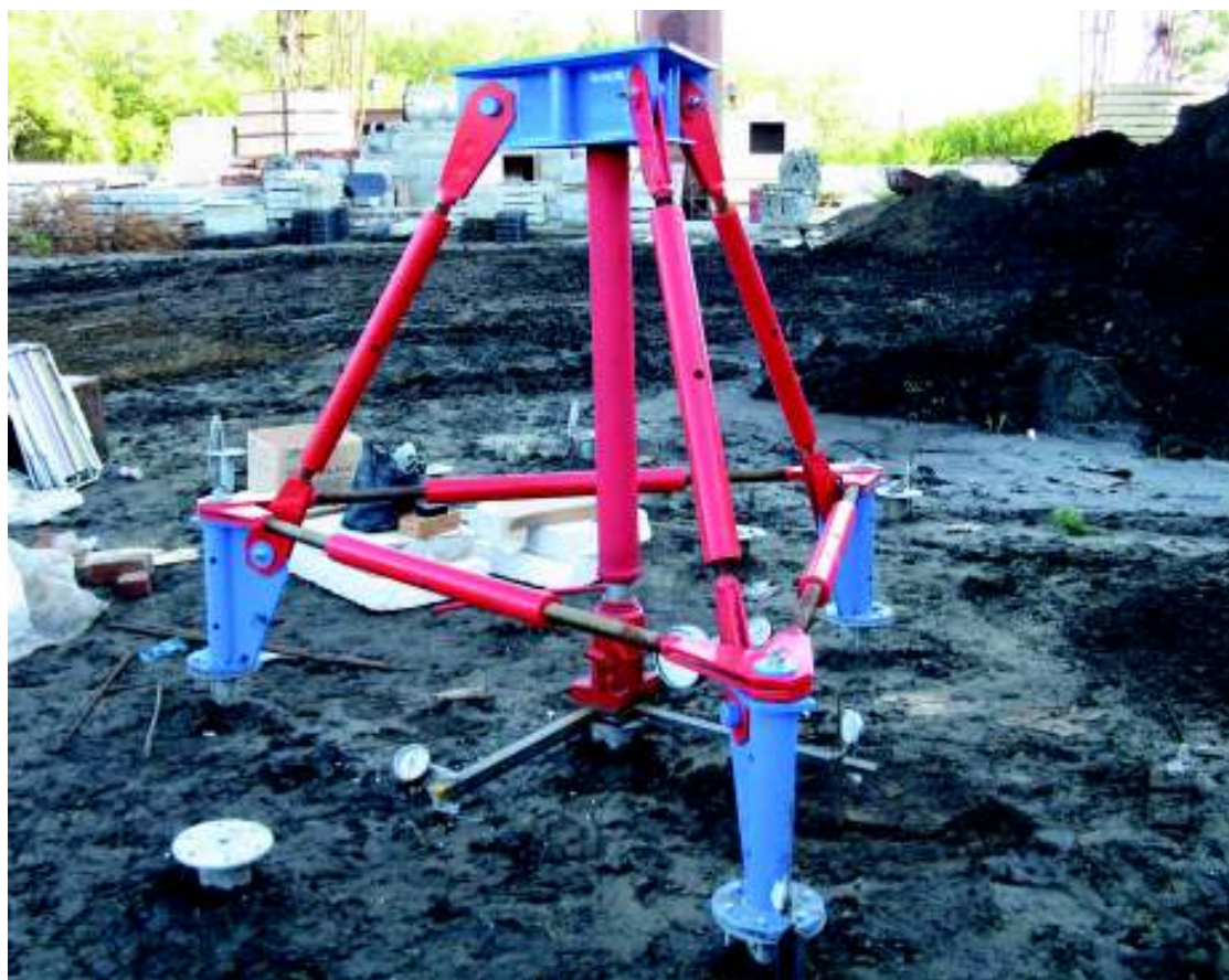
Фото 3- Стенд УУ-ВСК в полевых условиях ( испытания на вдавливание)
