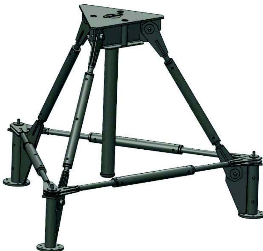
Рисунок 3- Схема станда (УУ-ВСК ) для испытания на вдавливание
