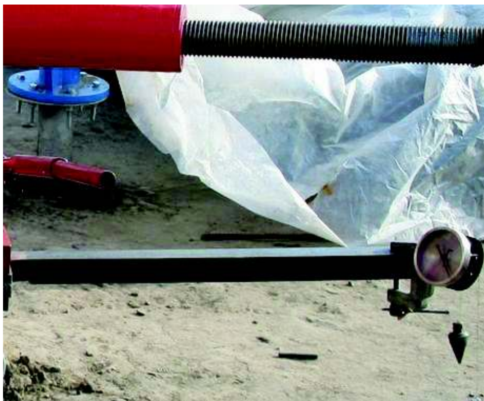
Фото 8- Установка прогибомеров Максимова ПМ-350 при испытании свай на вдавливание
